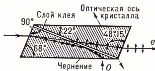
Рис. 1. Призма Николая. Штриховка указывает направление оптических осей кристаллов в плоскости чертежа. Направление электрических колебаний световых волн указаны на лучах стрелками (колебания происходят в плоскости рисунка) и точками (колебания перпендикулярны плоскости рисунка). O и e — обыкновенный и необыкновенный лучи. Чернение на нижней грани призмы поглощает полностью отражаемый от плоскости склейки обыкновенный луч. Клей — канадский бальзам.
